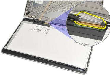
**8. Retire el ensamblaje de la pantalla de la base del equipo.**
