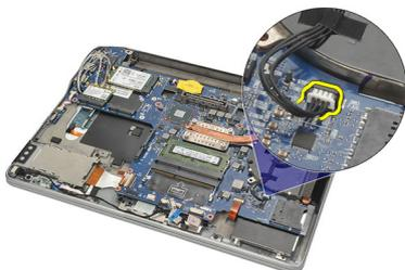
10. Afloje los tornillos cautivos del disipador de calor y extraiga el tornillo del abanico de la CPU.
