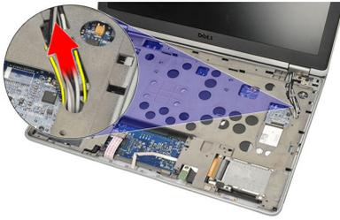
9. Extraiga los tornillos del soporte de la señalización del diferencial de baja tensión (LVDS).
