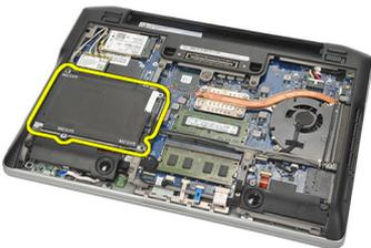
6. Extraiga los tornillos del soporte de la unidad de disco duro.
