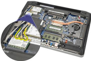
5. Extraiga el tornillo que fija la tarjeta WLAN al equipo.
