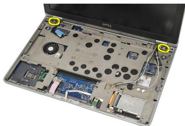
**13.** Retire el ensamblaje de la pantalla del equipo.
