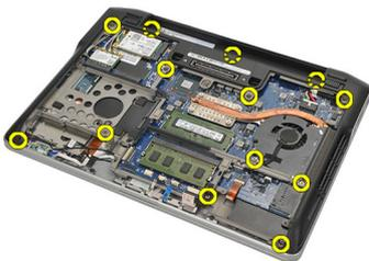
10. Comenzando desde la parte posterior del equipo, levante con cuidado el chasis de la parte posterior y desconecte la etiqueta del Certificado de Autenticidad (COA) del equipo antes de elevar toda la parte inferior del chasis.
