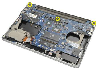
23. Levante el lado derecho de la placa base junto con los conectores USB y HDMI y tire de los cables de la antena inalámbrica desde la abertura de la placa base.
