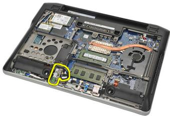
9. Desconecte el cable Bluetooth del módulo Bluetooth.
