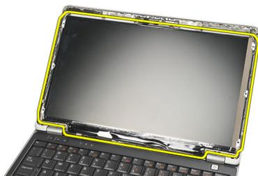
6. Retire la cinta adhesiva que fija la conexión de señalización del diferencial de baja tensión (LVDS) al panel de la pantalla.
