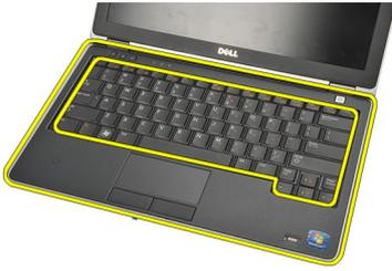
7. Saque el ensamblaje del reposamanos del equipo.
