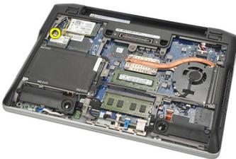
6. Extraiga la tarjeta WLAN del equipo.
