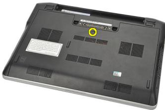
4. Deslice la cubierta de la base hacia la parte posterior del equipo para extraerla.
