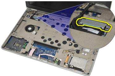
11. Desconecte el cable LVDS de la placa base.
