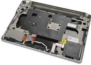
**20.** Deslice hacia afuera el compartimento de tarjetas inteligentes y extráigalo del equipo
