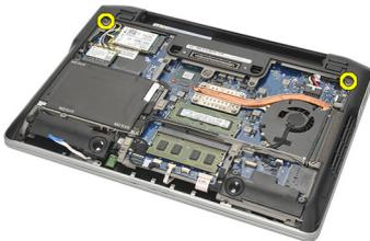
7. Desconecte todos los cables de la antena inalámbrica.
