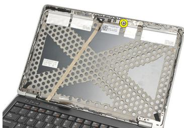
6. Extraiga la cámara y/o el micrófono desconectándolo del cable en la cubierta de la base de la pantalla.
