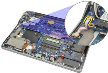
10. Extraiga el tornillo que fija el conmutador inalámbrico.
