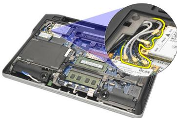
8. Déle la vuelta al equipo y levántelo con cuidado. Tire de los cables de la antena inalámbrica desde la abertura del equipo y desenrózquelos del soporte.
