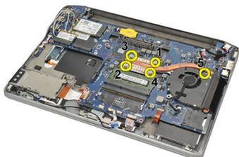
11. Extraiga el disipador de calor y el ensamblaje del abanico de la CPU.
