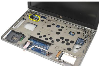
21. Déle la vuelta al equipo y desconecte los cables siguientes de la placa base:
