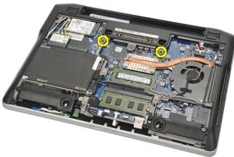
6. Déle la vuelta al equipo. Extraiga los tornillos del teclado.
