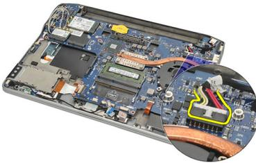
10. Levante y extraiga el conector de entrada de CC del equipo.
